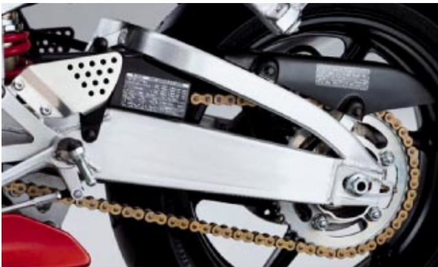
Nová zkosená kyvná vidlice z hliníkové slitiny
